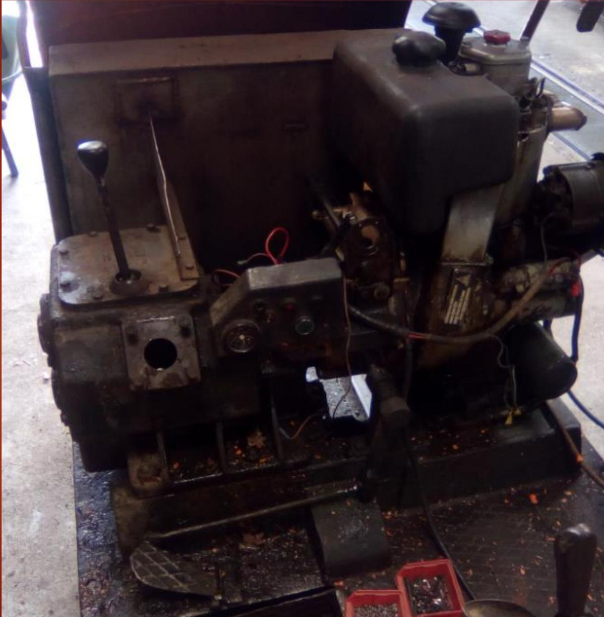
Il a bien travaillé cet hiver et mérite un peu d'entretien, réparation du levier d'accélérateur, suppression des fils en trop....., reprise du joint du levier AV/AR, contrôle des freins , réglage embrayage, puis nettoyage, grattage et peinture **résistante**.
